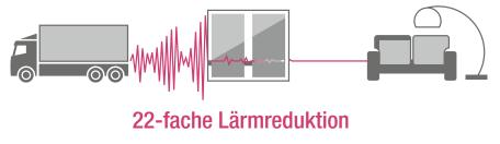
Quelle: Techniktabelle HUG Industrietechnik. Basis der Rechnung: Erhöhung des Schalls um 10 dB = Verdopplung der subjektiv empfundenen Lautstärke (LfU). Schallschutz Rw = 45 dB.
